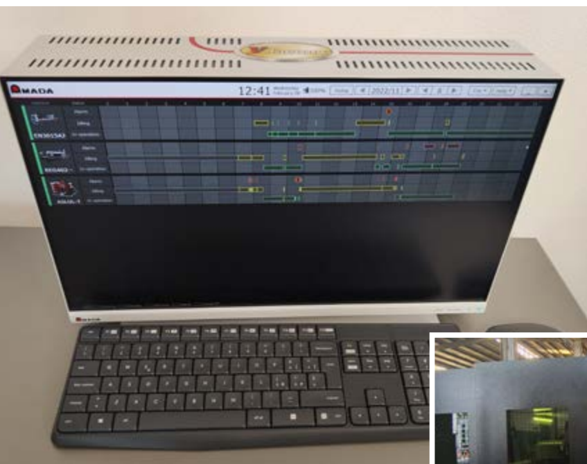
V-Factory, software di AMADA per industria 4.0, è un prezioso strumento per monitorare in real time tutto quello che avviene sulle macchine AMADA dotate del controllo AMNC 3i
